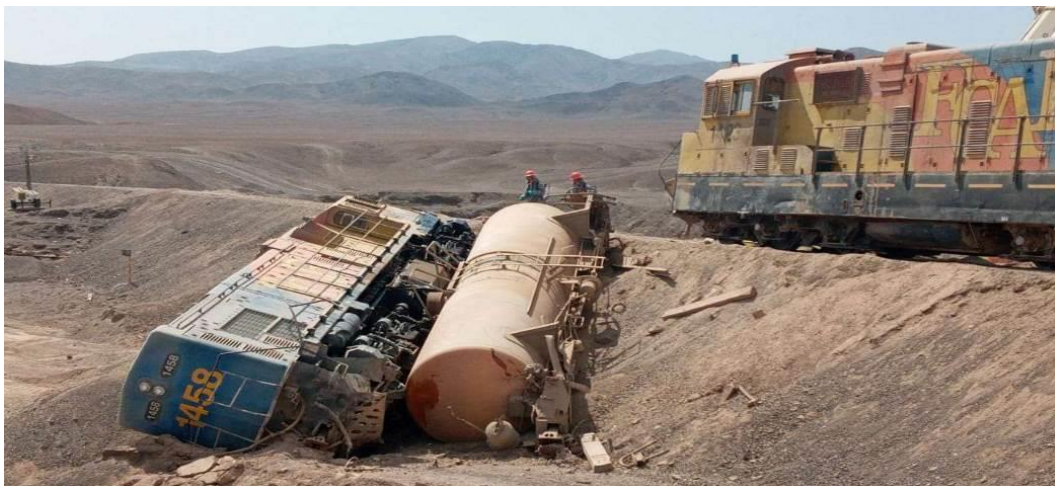
Imágenes N° 1 y 2. Riel quebrado y carros estanque de ácidos desrielados
